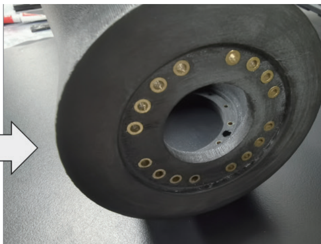
采用镶嵌黄铜套筒，耐久性大幅提高
