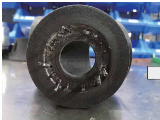
连续工作35h后，发生螺丝断裂失效
