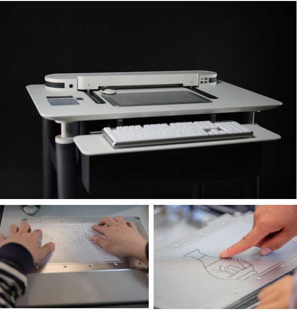
图2 触觉图形显示器原型，能够显示触觉文字或图像
