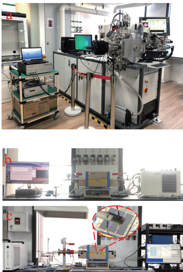
图 3 超清洁高温电化学测量系统 a: 脉冲激光沉积系统及原位表征平台, b: 超清洁高温基片处理平台, c: 超清洁高温电化学测量系统
