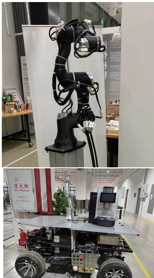
图4 碳纤维复合材料在服务型机器人和机械臂上的应用
