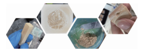
图 5 使用莫来石纤维增强地质聚合物并优化样品制备工艺
